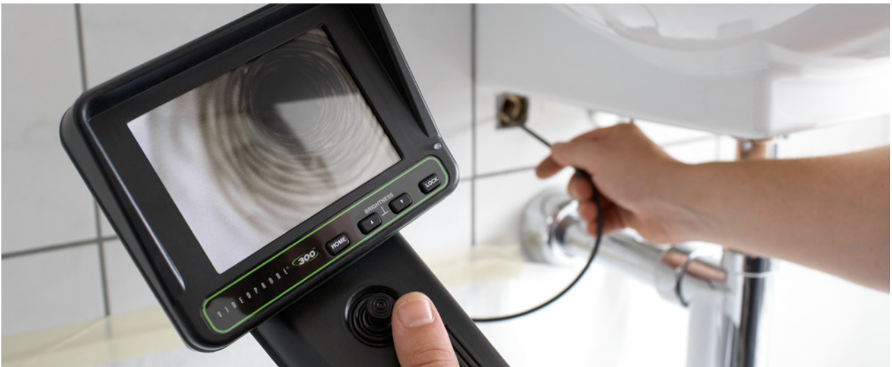
Analyse des Rohrzustandes mittels Endoskopie
